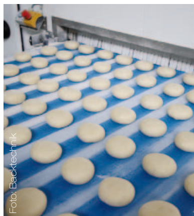
Bild links: Über einen kleinen Lamellenvorhang werden die Teiglinge aus der Absteifzone herausgeführt und vom Austrageband an die Fettpfanne übergeben. Bild rechts: Die fertig gebackenen Krapfen können noch etwas abtropfen, bevor die entsprechende Füllung injiziert wird.
