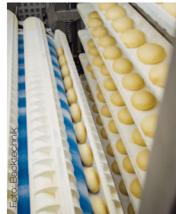
Bild links: Die großen Trögel bieten ausreichend Platz für die Entwicklung der einzelnen Teiglinge. Bild Mitte: Starke Ketten und mehrere Kettenspanner sorgen für eine hohe Laufruhe und einen geringen Verschleiß. Bild rechts: Am Ende der Absteifzone werden die Teiglinge aus den Gärgutträgern heraus an das Austrageband übergeben.
