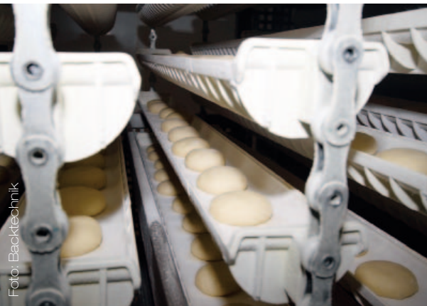
Bild links: Die großen Trögel bieten ausreichend Platz für die Entwicklung der einzelnen Teiglinge. Bild Mitte: Starke Ketten und mehrere Kettenspanner sorgen für eine hohe Laufruhe und einen geringen Verschleiß. Bild rechts: Am Ende der Absteifzone werden die Teiglinge aus den Gärgutträgern heraus an das Austrageband übergeben.
