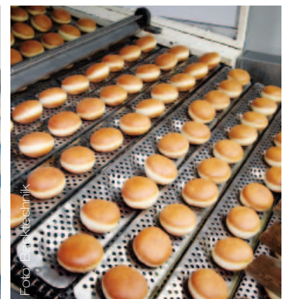
Bild links: Über einen kleinen Lamellenvorhang werden die Teiglinge aus der Absteifzone herausgeführt und vom Austrageband an die Fettpfanne übergeben. Bild rechts: Die fertig gebackenen Krapfen können noch etwas abtropfen, bevor die entsprechende Füllung injiziert wird.
